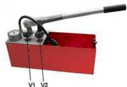
Po pripojení čerpadla, naplnení čerpadla a testovaného systému vodou, otvorení ventilu V1, a zatvorení ventilu V2 začnite čerpať vodu pomocou páky. Sledujte manometer. Po dosiahnutí požadovaného tlaku zatvorte ventil V1.
